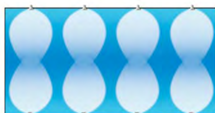
piscina da 8x16m n° 6/8 fari disposti su entrambi i lati 8x16m pool n° 6/8 floodlights placed on both sides
