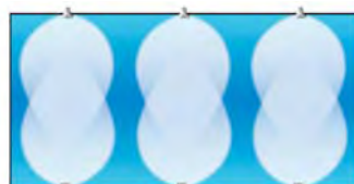
piscina da 6x12m n° 4/6 fari disposti su entrambi i lati 6x12m pool n° 4/6 floodlights placed on both sides
