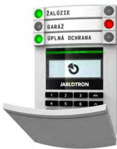
JA-114E je zbernicový prístupový modul **s LCD displejom, klávesnicou, ovládacím segmentom a RFID čítačkou.**
