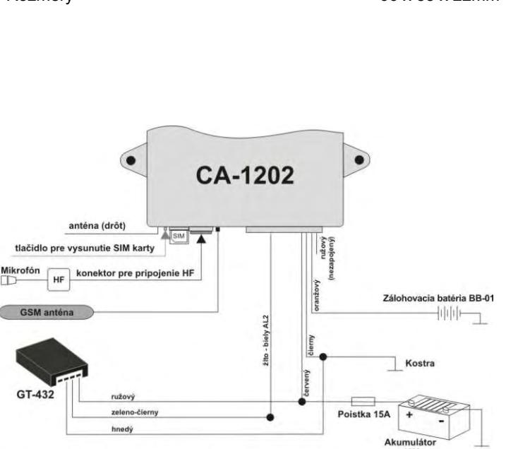
Obr. B: Príklad zapojenia GT-432 s GSM autoalarmom CA-1202 Athos.
