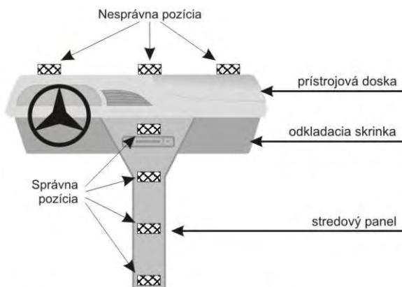
Obr. A: Pozícia mikrovlnného snímača vo vozidle.
