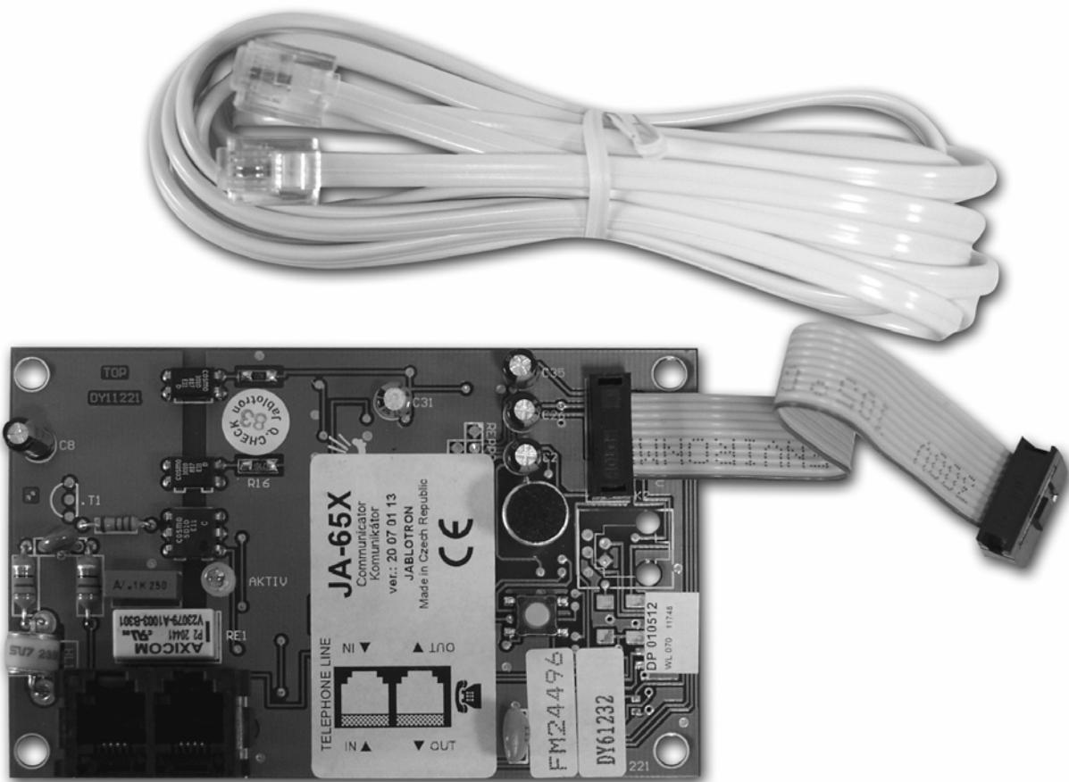
Komunikátor je určený pre ústredne JA-63 a JA-65. S nainštalovaným komunikačným modulom JA-65X je ústredňa schopná prenášať prostredníctvom analógovej pevnej linky poplachové hlasové správy, správy SMS, komunikovať s pultom centralizovanej ochrany a komunikovať so vzdialeným počítačom alebo klávesnicou JA-60E prostredníctvom modemu JA-60U.
